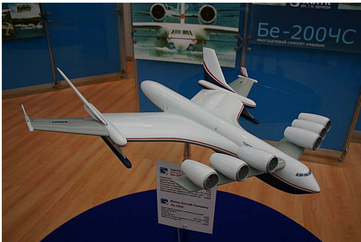
5. ábra. A Berijev Be-2500 ekranoplán gyári makettje
