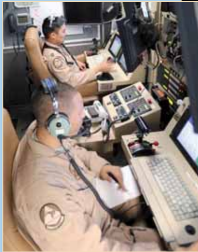
A nagy hatótávolságú gépeket műholdas adatkapcsolaton keresztül, akár földrészekkel távolabbról is irányítják a pilóták és az operátorok.
