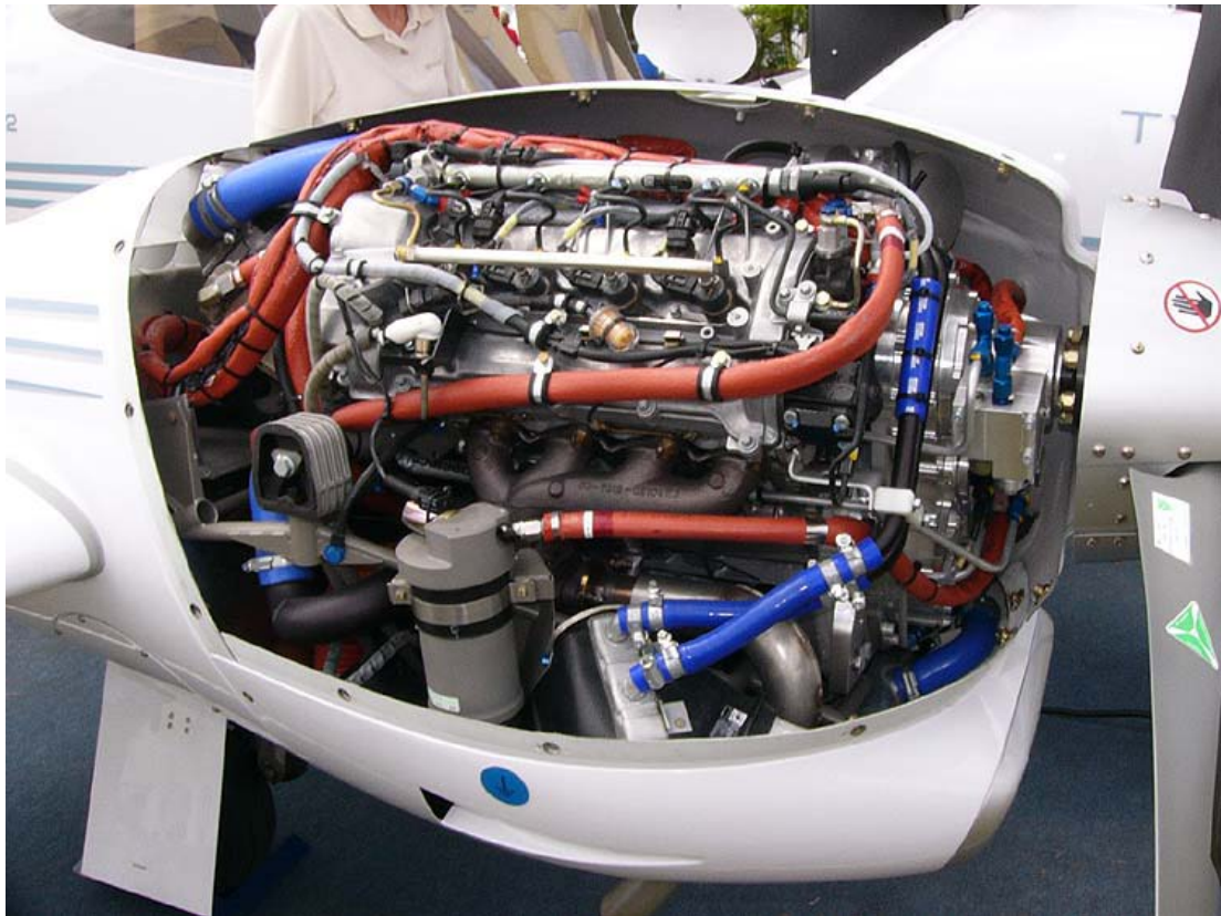
4.ábra. Diamond DA-42-be épített Thilert Centurion 1.7 dízelmotor [5]
