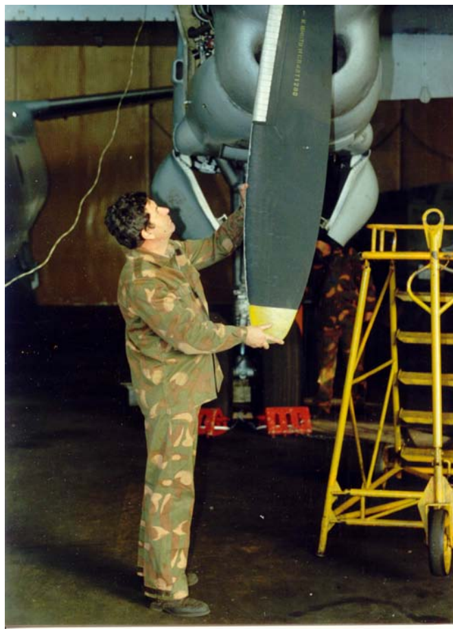
4. ábra. Légcsavarlapát ellenőrzése An-26 típusú repülőgépen
