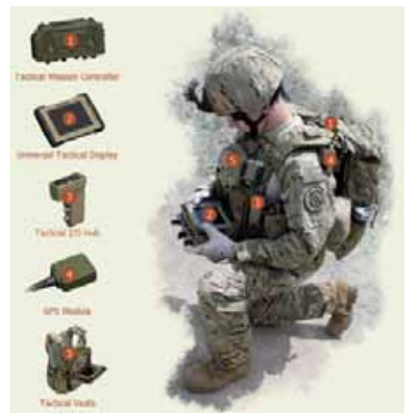
11. KÉP A MODULAR TACTICAL SYSTEM EGYMAGÁBAN TARTALMAZZA A REPESZÁLLÓ MELLÉNYRE SZERELT RÁDIÓT, A GLOBÁLIS HELYMEGHATÁROZÓT, A VIDEOJEL VÉTELÉRE ALKALMAS BERENDEZÉST ÉS A SZÜKSÉGES KIJELZŐT
