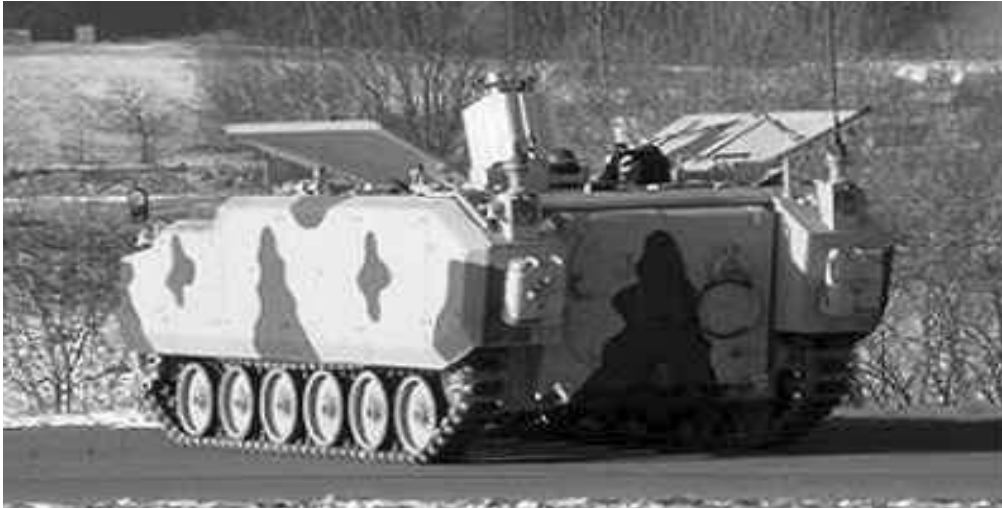
8. kép Bighorn típusjelű 120 mm-es önjáró aknavető
