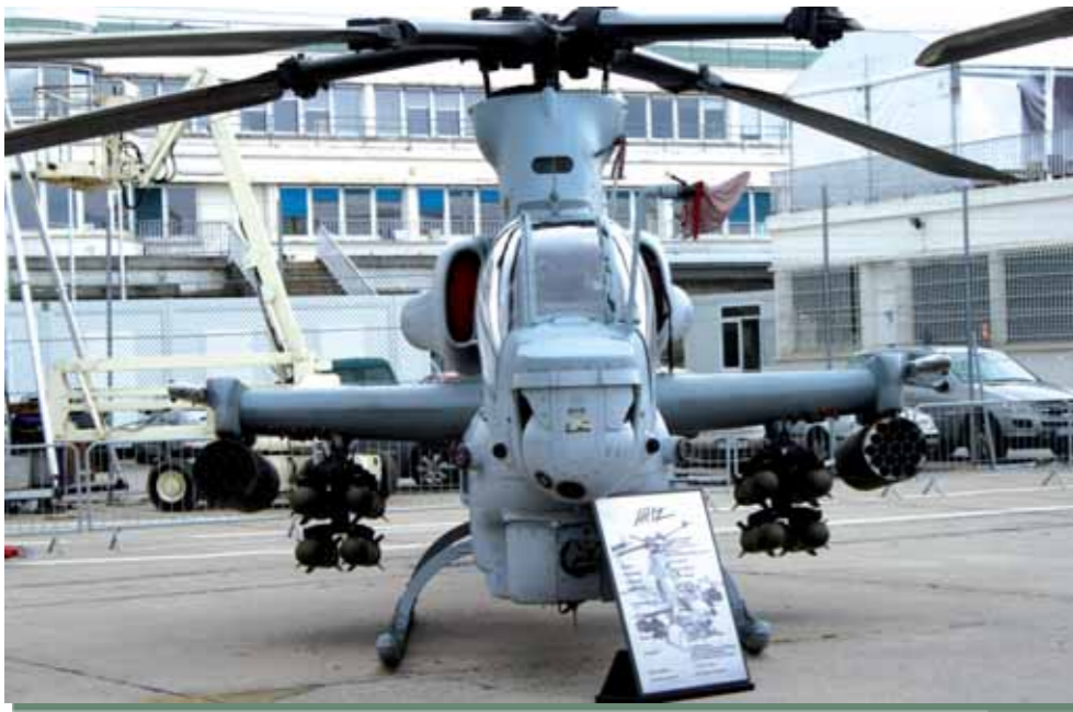
TISZTELET PARANCSON A BELL AH-1Z VIPER TÍPUSÚ KÉTHAJTÓMŰVES TÁMADHÉLIKOPTER, AMELYNEK ELŐDJÉT, AZ AH-1W SUPERCOBRÁT AZ AMERIKAI HADITENGERÉSZET ELITEGYSÉGE (MARINE CORPS) FELADATAIRA SZABVA ÉS IGÉNYEI SZERINT FEJLESZTETTÉK KI. A KESKENY TÖRZSET STABILIZÁLÓ SZÁRNYCSONKOK JÓL LÁTHATÓAN TEHERVISELŐ CÉLT IS SZOLGÁLNAK
