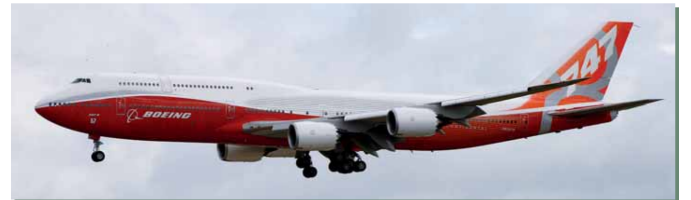
ÉRKEZIK A 442 TONNA MAXIMÁLIS FELSZÁLLÓSÚLYÚ, A 747-400-ASNÁL CSAK NEM 6 M-REL, DE A VILÁG JELENLEGI LEGNAGYOBB UTASSZÁLLÍTÓ REPÜLŐGÉPÉNÉL, AZ AIRBUS A380-800-ASNÁL IS 3,5 M-REL HOSSZABBRA SZABOTT, 76,25 M HOSSZÚ BOEING 747-81 (INTERCONTINENTAL)
