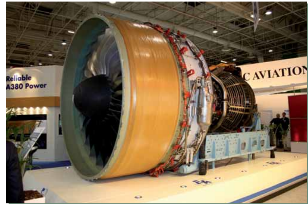
A HAJTÓMŰ MÉRETE HATALMAS: 4,74 M HOSSZÚ A KIÖMLŐNYÍLÁSIG; BRUTTÓ ÁTMÉRŐJE 3,16 MÉTER, TURBINAPÁTJAINAK FORGÁSI ÁTMÉRŐJE 2,95 M; KENŐANYAGOK NÉLKÜLI SZÁRAZ SÚLYA 6700 KG; EGYENKÉNTI TOLÓEREJE PEDIG ELKÉPESZTŐ: 363 kN
