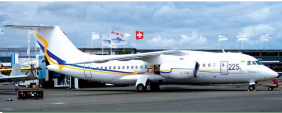
AZ AN-148-AS 5 M-REL MEGNÖVELT TÖRZSHOSSZÚ VÁLTOZATA AN-158 TÍPUSNÉVEN SZEMÉLYESEN IS BEMUTAKOZTOTT. MEGGYŐZŐ VOLT A REPÜLŐGÉP RENDKÍVÜLI FORDULÉKONYASÁGA ÉS DINAMIKÁJA. MEGLEHETŐSEN CSENDES, 64 kN TOLÓERŐT BIZTOSÍTÓ, D-436 TÍPUSÚ HAJTÓMŰVE AZ IVCSENKO PROGRESS ÉS A MOTOR SICH OROSZ TERVEZŐ IRODÁK KÖZÖS FEJLESZTÉSE
