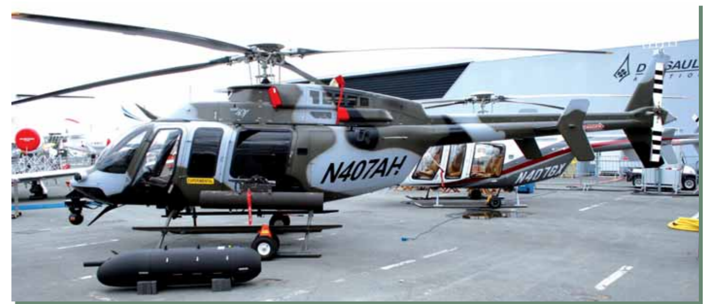
A BELL 407AH JOBB OLDALÁN EGY DILLON M-134T TÍPUSÚ TÁVIRÁNYÍTÁSÚ, 7,62-ES GÉPPUSKA, A BAL OLDALÁN PEDIG (A KÉPEN) A CSÜSZÓTPAL FÖLÉ SZERELVE EGY M260 TÍPUSÚ, HÉTLÖVÉES GRÁNÁTVÉTŐ LÁTHATÓ
