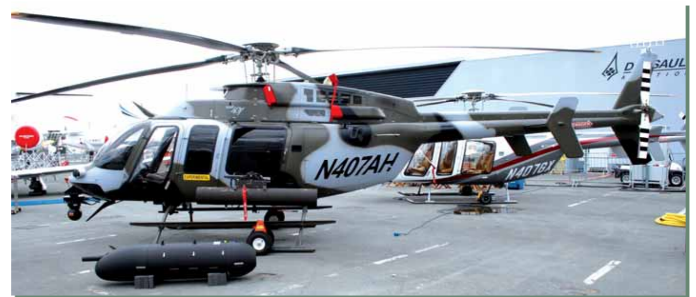
A BELL 407AH JOBB OLDALÁN EGY DILLON M-134T TÍPUSÚ TÁVIRÁNYÍTÁSÚ, 7,62-ES GÉPPUSKA, A BAL OLDALÁN PEDIG (A KÉPEN) A CSÜSZÖTPAL FÖLÉ SZERELVE EGY M260 TÍPUSÚ, HÉTLÖVÉES GRÁNÁTVETŐ LÁTHATÓ
