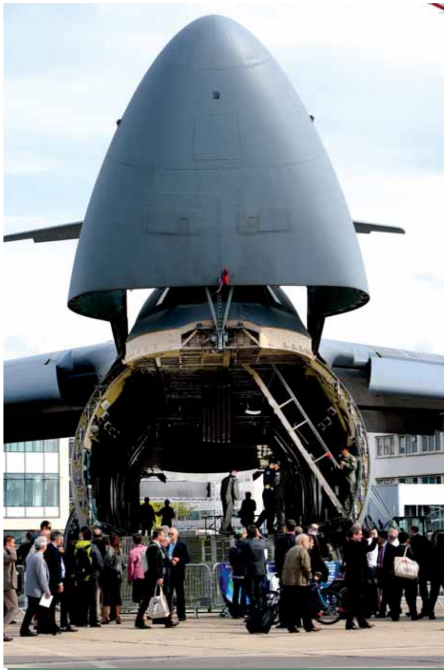
AZ AMERIKAI LÉGIERŐ KORSZERŰSÍTETT LOCKHEED C-5-ÖSE, AMINT ÁRUFOGADÁSRA TÖRTÉNŐ FELKÉSZÜLÉST IMITÁL. ENNEK A SUPER GALAXYNAK ÚJ REPÜLÉSI RENDSZERE ÉS ÚJ TÍPUSÚ HAJTÓMŰVEI MIATT A TÍPUSJELE C-5M-RE MÓDOSULT (OLDALSÁMA: 86-0025). KI HINNÉ, HOGY A TÍPUS C-5A ALAPVARIÁNSAI MÁR VIETNAMBA IS SZOLGÁLTAK...
