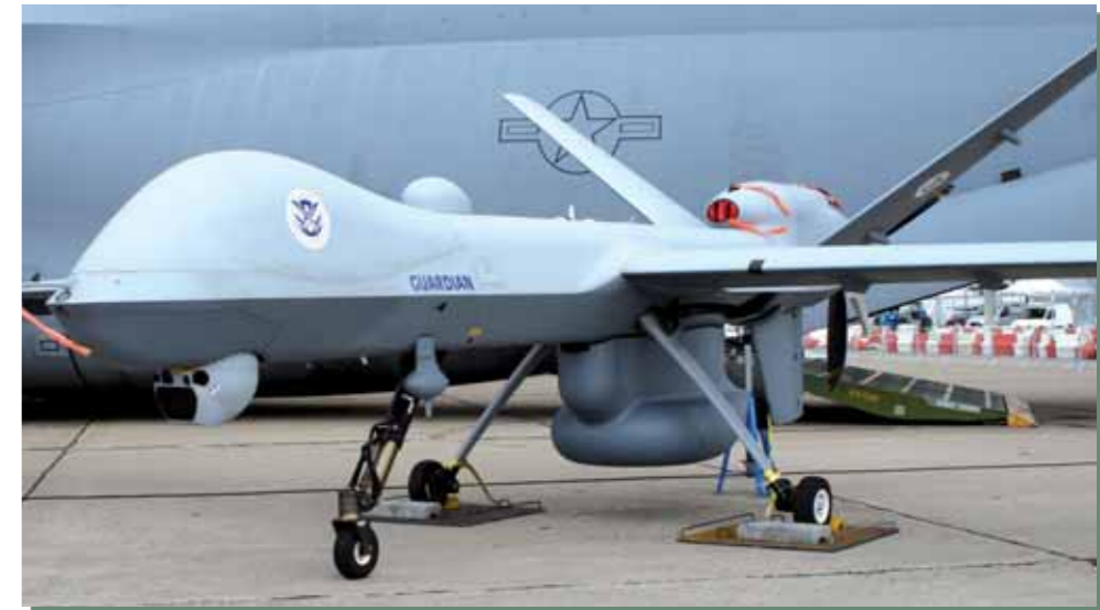
AZ AMERIKAI VÉDELMI MINISZTERIUM (DoHS) MEGRENDELÉSÉRE A GENERAL ATOMICS ÁLTAL GYÁRTOTT MQ-9B GUARDIAN TÍPUSJELŰ FELDERÍTŐ ROBOTREPÜLŐGÉP
