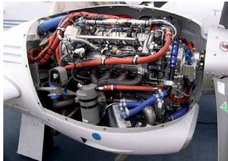
DIAMOND DA-42-BE ÉPÍTETT THIELERT CENTURION 1.7 DÍZELMOTOR
