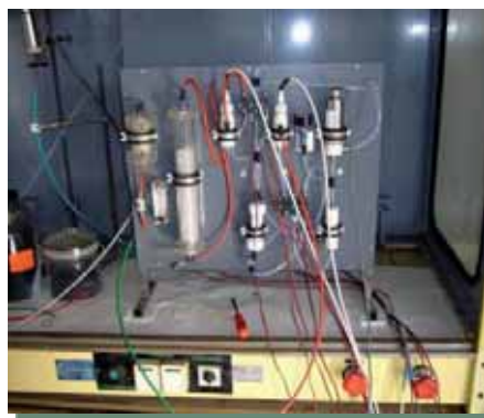
5. ÁBRA: HCN-PENETRÁCIÓT MÉRŐ BERENDEZÉS FÉNYKÉPE
