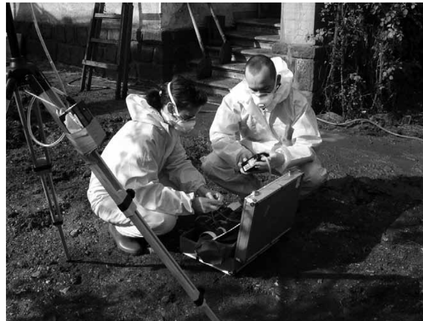
A víz pH-értékének mérése
