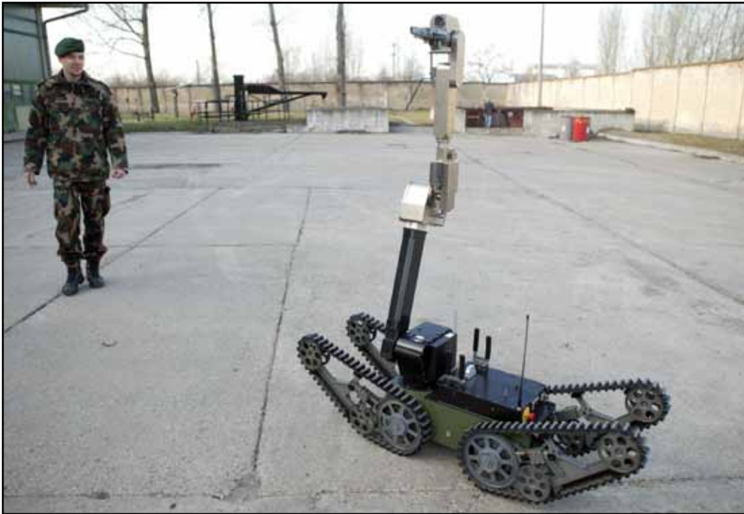
▲ A RÁDIOVEZÉRELT TELEMAX KÖNNYŰ TŰZSZERÉSZROBOT THE RADIO-CONTROLLED TELEMAX LIGHT EOD ROBOT
