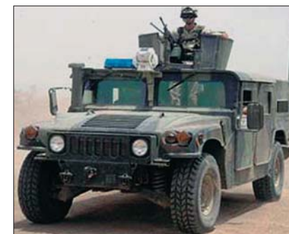
72. számú kép: HMMWV kezdetleges tornnyal
