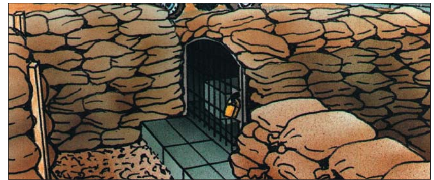
77. számú ábra: Példák egyszerű üzemanyag- és lőszerraktárak kialakítására
