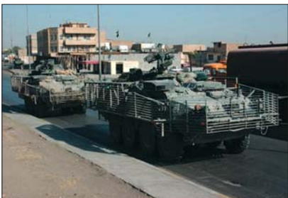
75. számú kép: RPG elleni oldalrácsozat a Stryker
