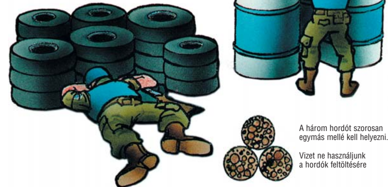
79. számú ábra: Példák egyszerű óvóhelyek és tüzelőállások kialakítására
