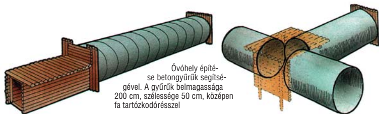
84. számú ábra: Példák egyszerű óvóhelyek építésére
