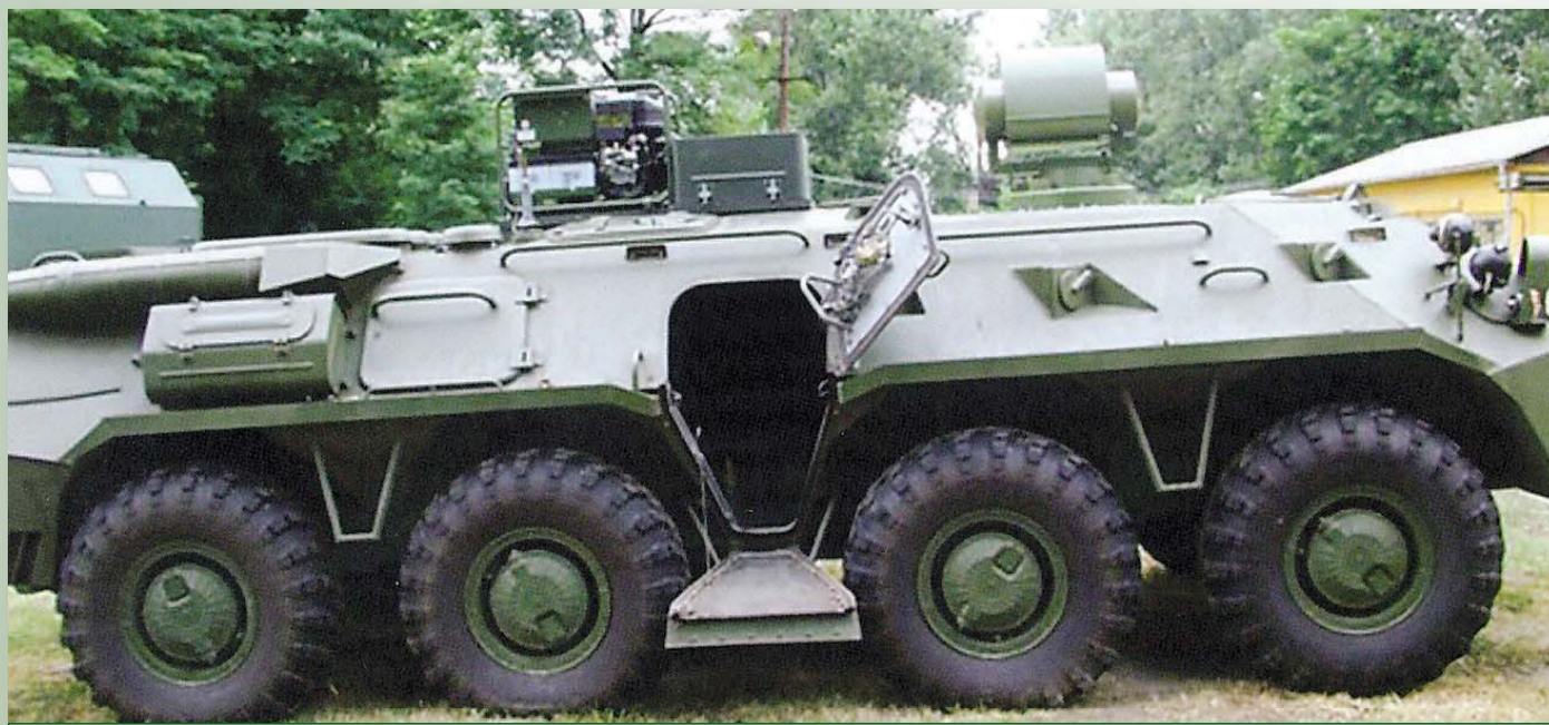
A század-tűzfigyelő és -tűztámogató rendszer a BTR-80-ba beépítve
